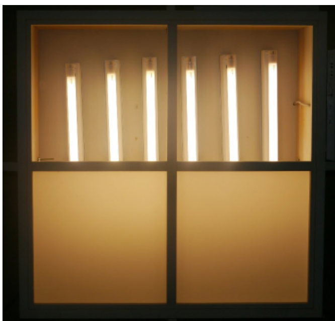
Abbildung 2: Blick in eine teilgeöffnete LEUCHTE mit LED-Röhren
